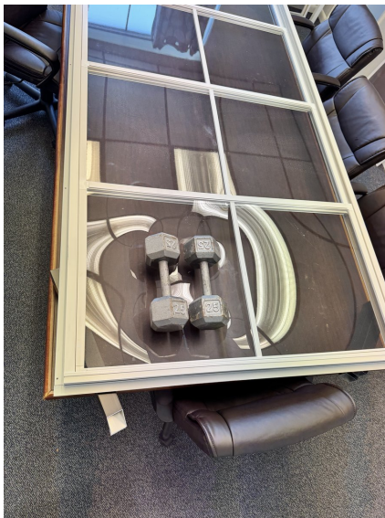
Fig. A.4.3-a: 50 lbf on infill center
